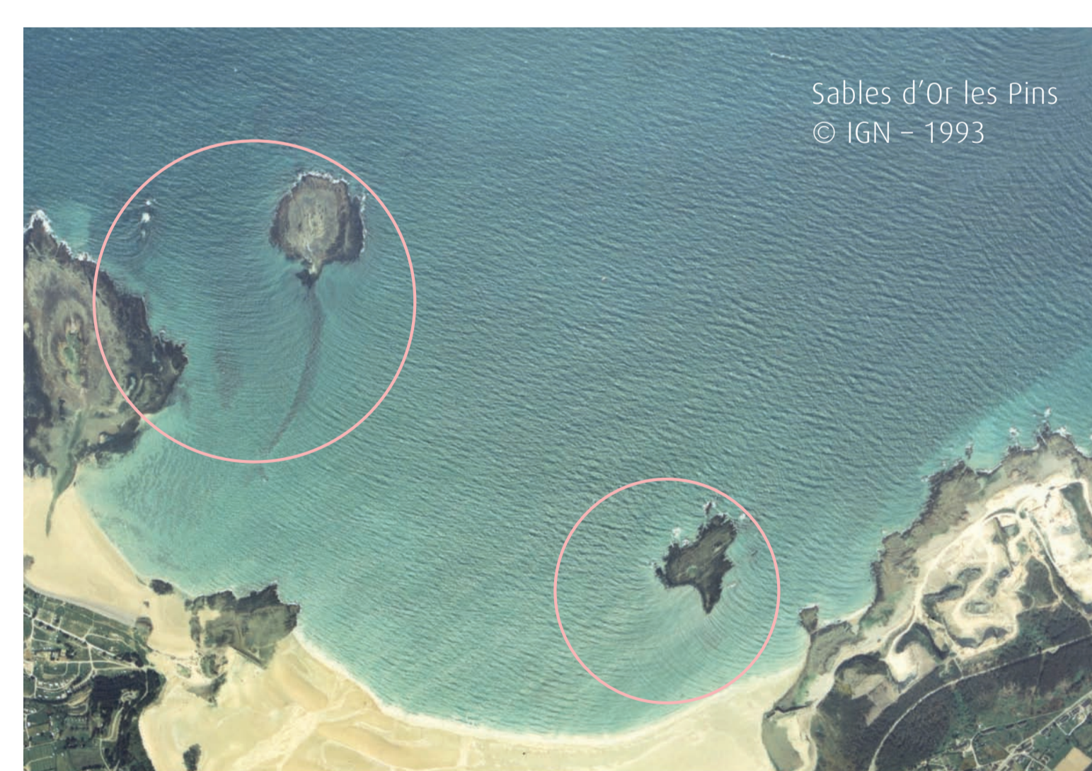
Diffraction des houles autour des îlots rocheux
